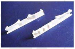
Foto links: Die Höhe des eingepassten Seitenteils beträgt 27mm, gemessen im Bereich der senkrechten Karosseriesicke (vgl. Pfeil)
